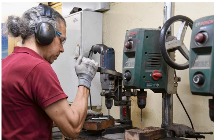
Stefan Wehrli bohrt Löcher in ein Hufeisen.
